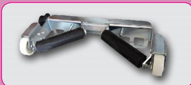
Scala a scalata manuale per palificazioni conduttori
